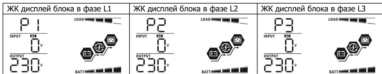
Шаг 4. Включите все автоматические выключатели перемен. тока в линейных проводах входа перемен. тока. Если обнаружено соединение переменного тока и три фазы соответствуют настройкам блока, система функционирует в штатном режиме. В противном случае начнет мигать значок и блоки не будут функционировать в режиме работы от линии.
