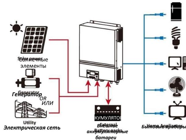
**Рисунок 1. Общая схема гибридной фотоэлектрической системы**
