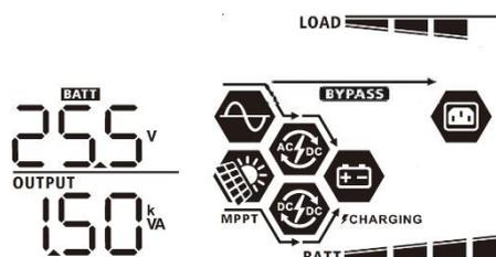
нагрузки в В·А отображается в виде x.x кВ·А, как показано на следующем рисунке.
