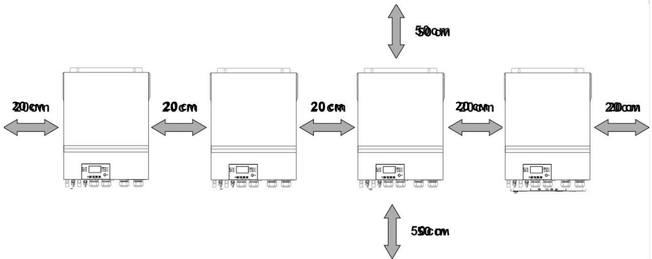
**ПРИМЕЧАНИЕ.** Для обеспечения соответствующей циркуляции воздуха с целью отвода тепла, зазор с боковых сторон блока должен быть приблизительно 20 см, а сверху и снизу блока — приблизительно 50 см. Все блоки должны быть расположены на одной высоте.
