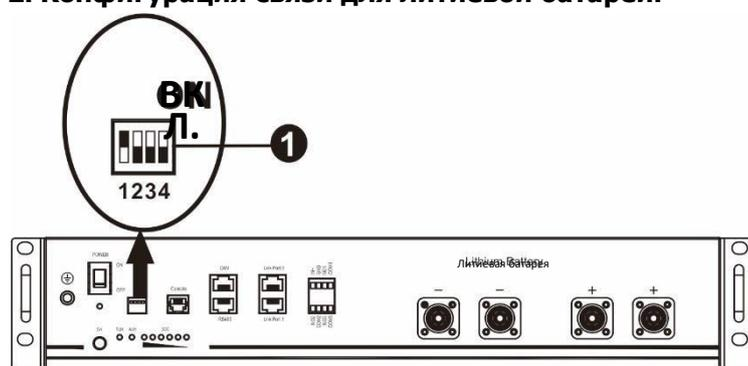
① Микропереключатель. Имеется 4 микропереключателя, задающие различную скорость передачи данных и адреса групп батарей. Положение микропереключателя «OFF» [выключено] соответствует значению «0». Положение микропереключателя «ON» [включено] соответствует значению «1».
