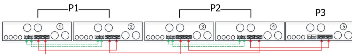
Два инвертора для одной фазы и только один инвертор для остальных двух фаз
