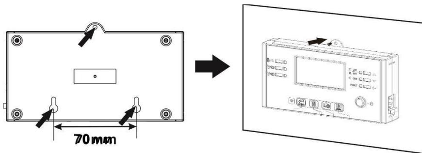
**Примечание.** Монтаж на стене следует выполнять с помощью соответствующих винтов, показанных на рисунке справа.
