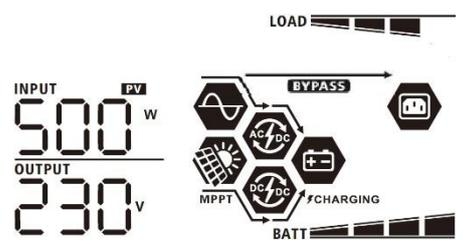
Мощность фотоэлектрической панели 1 = 500 Вт
