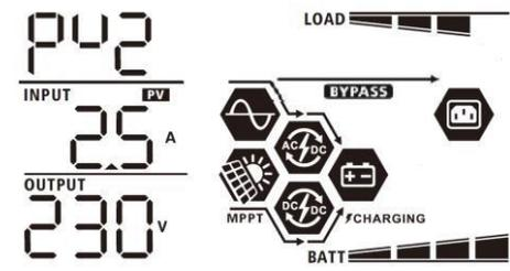
Мощность фотоэлектрической панели
