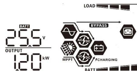
нагрузки в ваттах отображается в виде x.x кВт, как показано на следующем рисунке.
