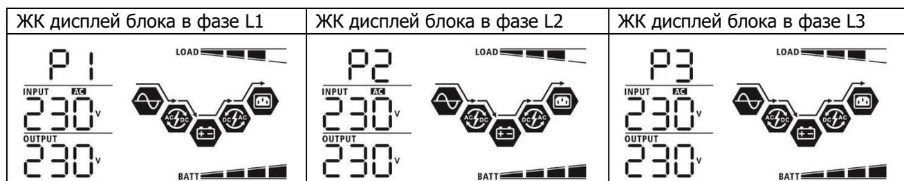
Шаг 5. Если оповещение о неисправности больше не появляется, установка системы для питания трехфазного оборудования полностью завершена.
