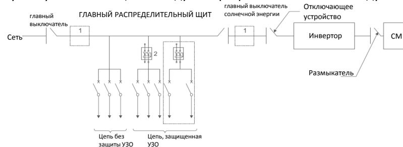
Рисунок 5.26 – Пример организации сетевой электростанции
